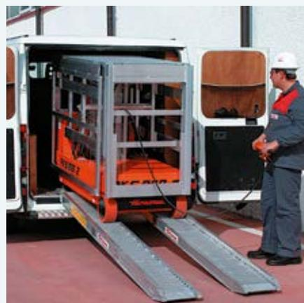
Hubarbeitsbühne PKS880, mehr als 8 Meter Höhe, leicht in einem Flachdach-Kastenwagen transportierbar.
