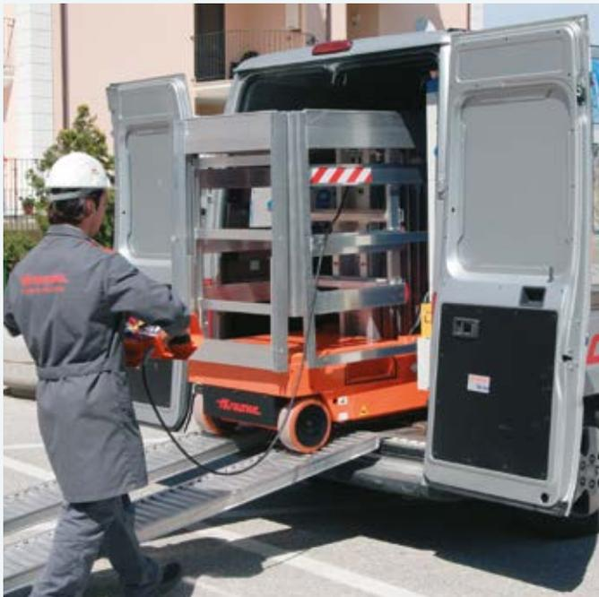
Über 10 Meter Höhe und Sie transportieren Sie in einem normalen Hochdach-Kastenwagen.
