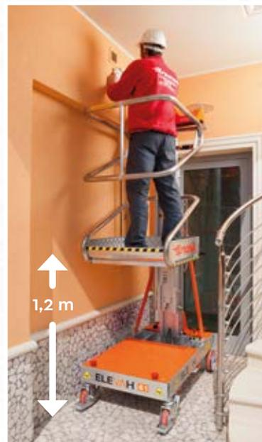
Diese kleine Mastbühne ist einfach manuell zu verschieben (max Schub im Gang = 3Kg)
