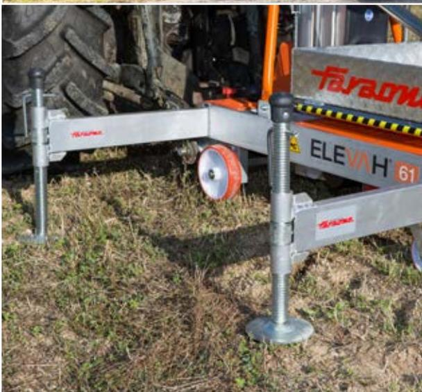
Die vier Stützen gestatten eine korrekte Nivellierung des Geräts.
