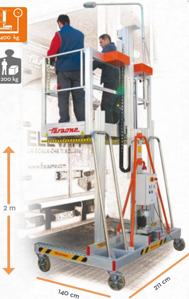
Montageplattform für zwei Arbeiter (Arbeitsfläche 84 x 180 cm) mit Stromversorgung 220 V und einer Arbeitshöhe von 4 m. Mögliche Modifizierungen nach Kundenwunsch.
