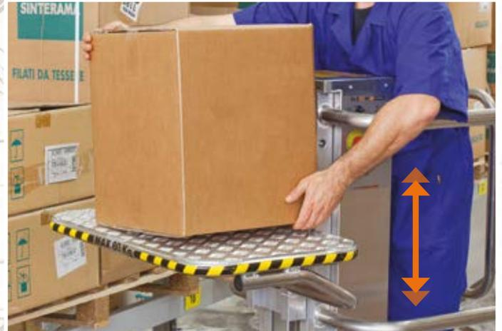
Geräumige, automatisch höhenverstellbare Ablagefläche.
