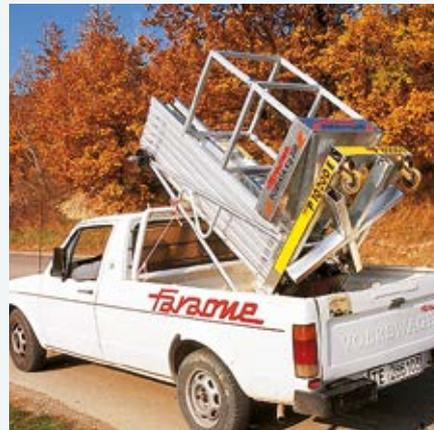
In einem kleinen Pickup transportieren Sie eine Hubarbeitsbühne mit über 14 m Höhe.
